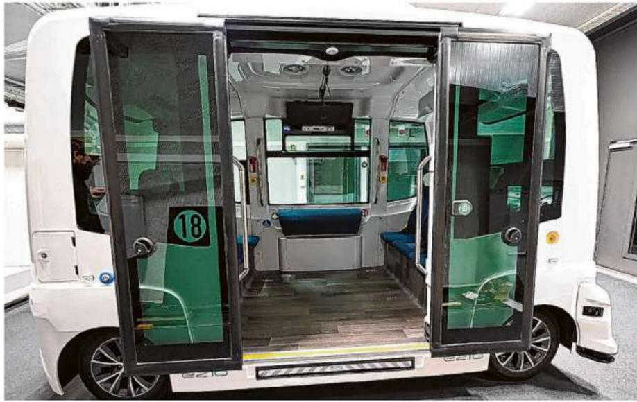
Barrierefrei: Die Türen öffnen sich zur Seite, dann wird das Fahrzeug etwas abgesenkt, und es fährt automatisch die Rampe herunter. Fotos (2): Jürgen Scholz
